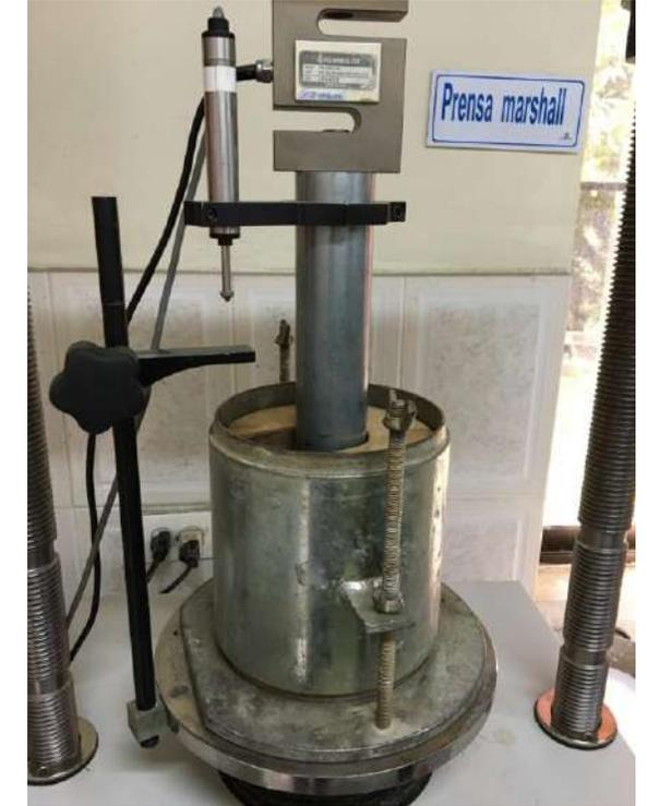
Ensayo de CBR en laboratorio
